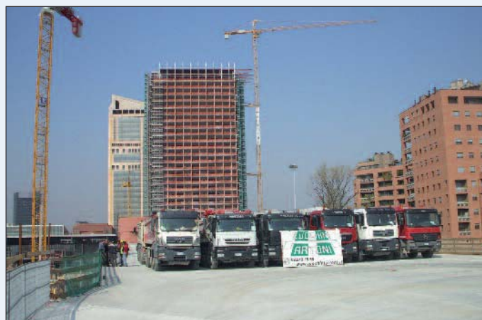
Figura 30 - Il collaudo eseguito con 12 autotreni a pieno carico con portata di 440 q cadauno
